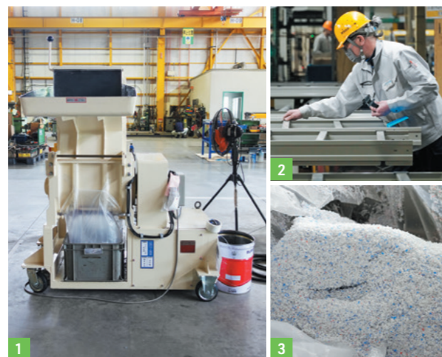
1. PPバンド粉砕機 2. ケーブルラックに保護パッキンを付けている様子 3. 粉砕したPPバンド
