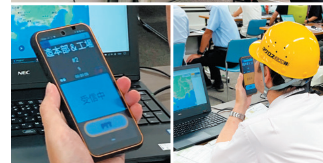
ハザードトークは災害時に通信の安定性を確保するために設計された通信機器となっており、専用の電波を使用するため通常の携帯電話に比べ通信障害が発生しにくい仕様になっています。
